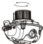
Twist zaključavanje tipki s anti-smjeru kazaljke na satu, da skinu filter.
