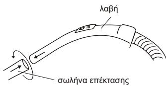
Τοποθετήστε τα ακόλουθα εξαρτήματα μέσα στο σωλήνα με στροφική δύναμη.
