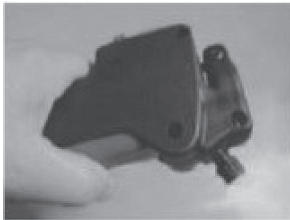
Заводская установка положение дроссельной замка регулировочного винта полностью разблокирован.
