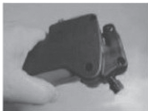
Fabrică Poziția de blocare de control de accelerație șurub complet deblocat.
