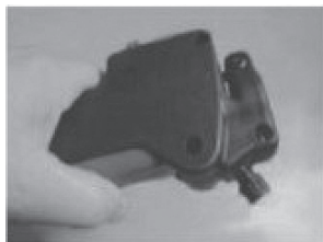
Tvornica postaviti položaj leptira za kontrolu zaključavanje vijak potpuno otključana.
