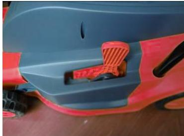
**Предупреждение:** При косене не позволявайте на мотора да работи в тежки условия. Когато двигателят работи, оборотите на мотора ще паднат и ще чуете промяна в звука на двигателя. Когато това се случи, спрете да косите, освободете лоста на превключвателя и повдигнете височината на рязане. Ако не направите това, може да повредите машината.
