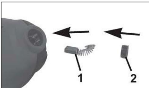
Izvadite i provjerite ugljene četkice nakon dužeg korištenja. Zamijenite ih se nosi. Četke trebaju biti čisti, slobodno kliziti gore-dolje u držač. Oba četke treba zamijeniti u isto vrijeme kao par.
