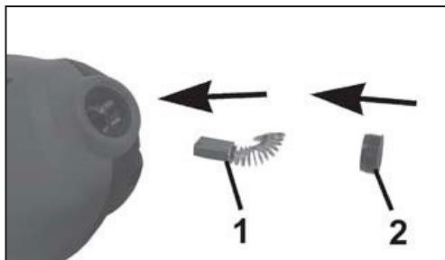
Odstranite in preverite, ogljene ščetke po daljši uporabi. Jim Pri obrabi zamenjajte. Krtače je treba čistiti in prosimo, da stran gor in dol v držalo. Oba krtače je treba zamenjati ob istem času kot par.
