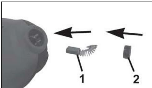
Retire y compruebe las escobillas de carbón después de un uso prolongado. Sustituirlos en caso de desgaste. Los cepillos deben mantenerse limpios y libres para deslizarse hacia arriba y hacia abajo en el soporte. Ambos cepillos deben ser reemplazados al mismo tiempo como un par.
