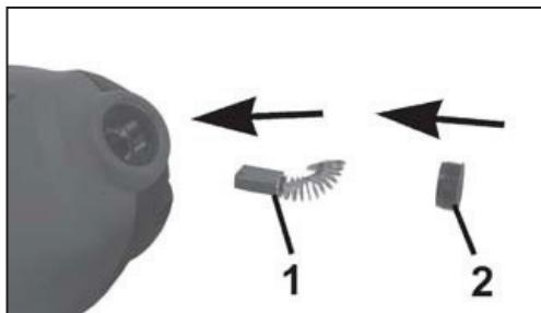
Retirez et vérifiez les balais de charbon après une utilisation prolongée. les remplacer en cas d'usure. Les brosses doivent être propres et libres de glisser vers le bas et dans le support. Les deux brosses doivent être remplacés en même temps que deux.
