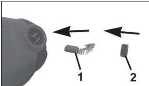
Scoateți și verificați perii de carbon după utilizare prelungită. Înlocuiți-le atunci când purtat. Perii ar trebui să fie păstrate curate și fără a aluneca în sus și în jos în suportul. Ambele perii ar trebui înlocuite în același timp ca o pereche.
