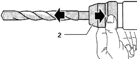
Trageți manșon de blocare (5) înapoi și deconectați instrumentul.
